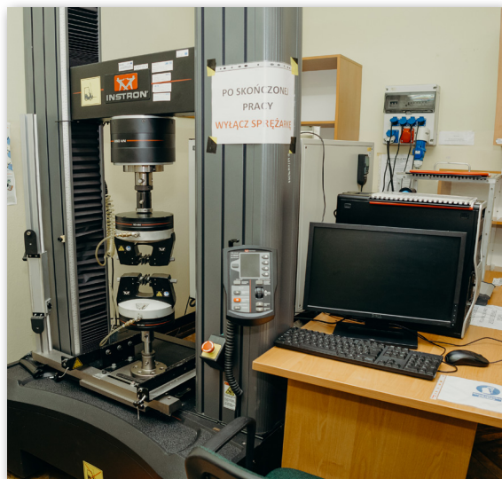
Maszyna wytrzymałościowa o maksymalnej obciążalności do 250 kN (INSTRON 3119-410)
