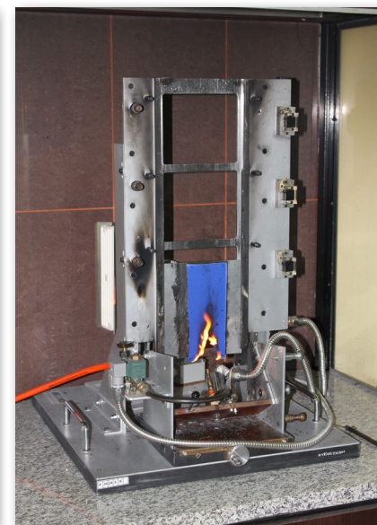
Test zapalności tkaniny bawełnianej zgodnie z normą PN-EN ISO 6940
