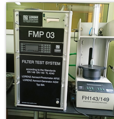
Aparat do badania właściwości filtracyjnych metodą mgły olejowej LORENZ FMP 03
