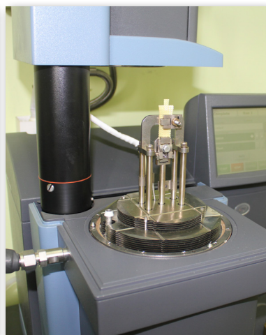
Dynamiczny termo-mechaniczny analizator model DMA Q800 firmy TA Instruments
