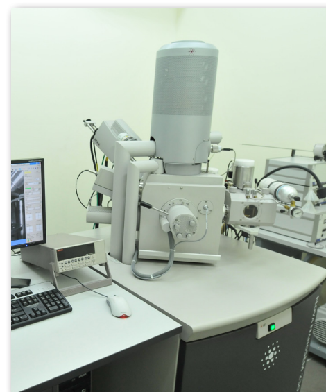
Wysokorozdzielczy skaningowy mikroskop elektronowy NOVA nanoSEM 230 firmy FEI z mikroanalizatorem rentgenowskim EDS Apollo firmy EDAX
